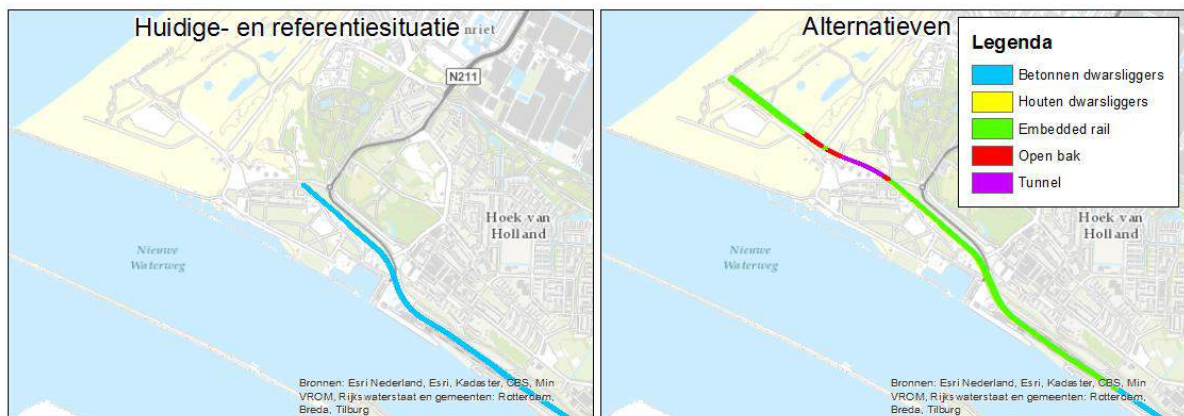
Figuur 2.5 Bovenbouwconstructie in de huidige en Referentiesituatie (links) en het alternatief Ombouw + Verlenging (rechts) voor Hoek van Holland
