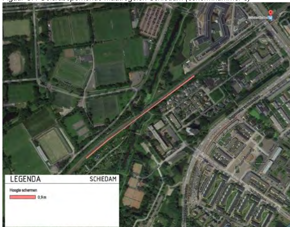
Figuur S.4 Geluidbeperkende maatregelen Schiedam (schermnummer 6)
