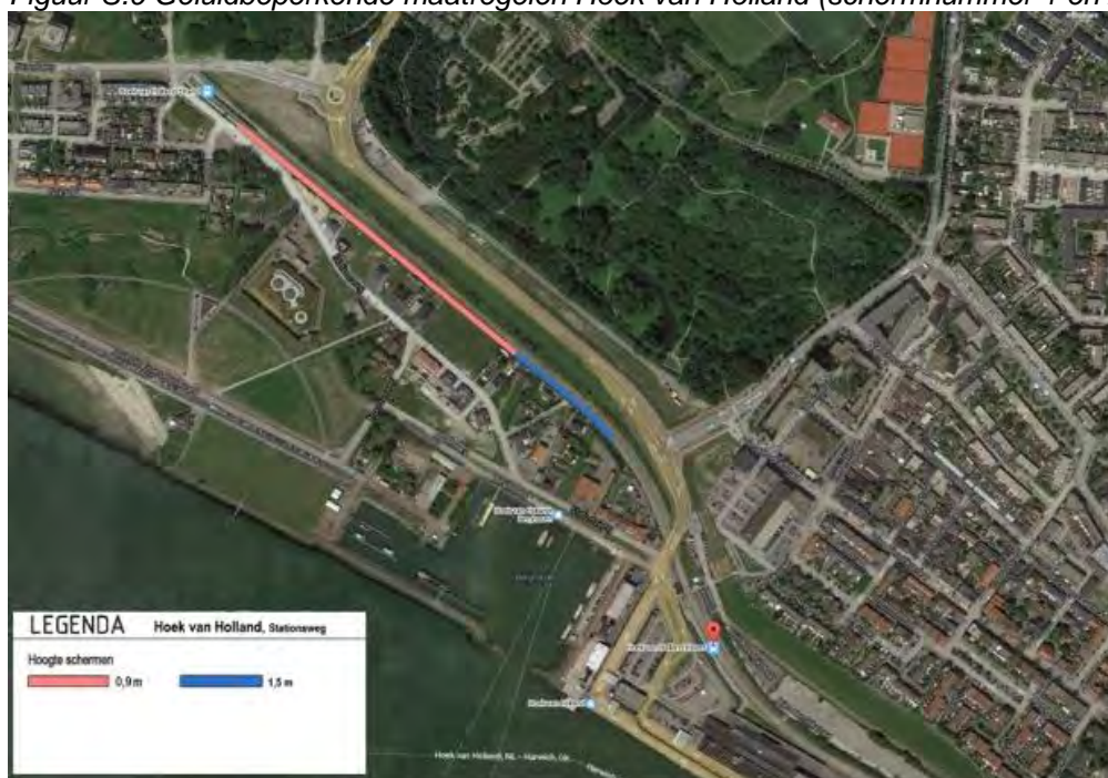
Figuur S.9 Geluidbeperkende maatregelen Hoek van Holland (schermmummer 1 en 2)
