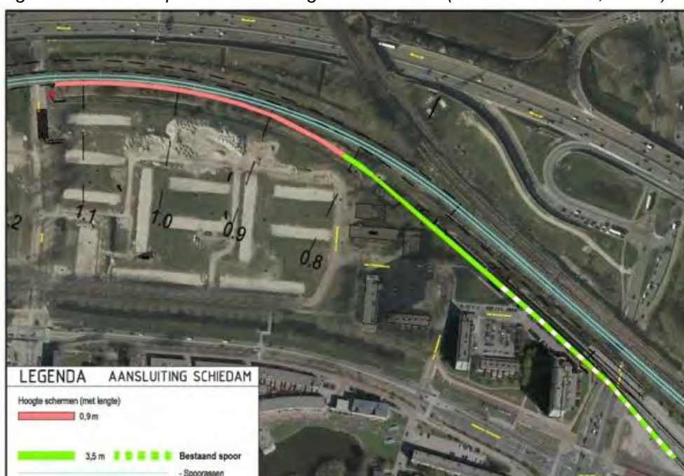
Figuur S.2 Geluidbeperkende maatregelen Schiedam (schermmnummer 1, 2 en 3)
