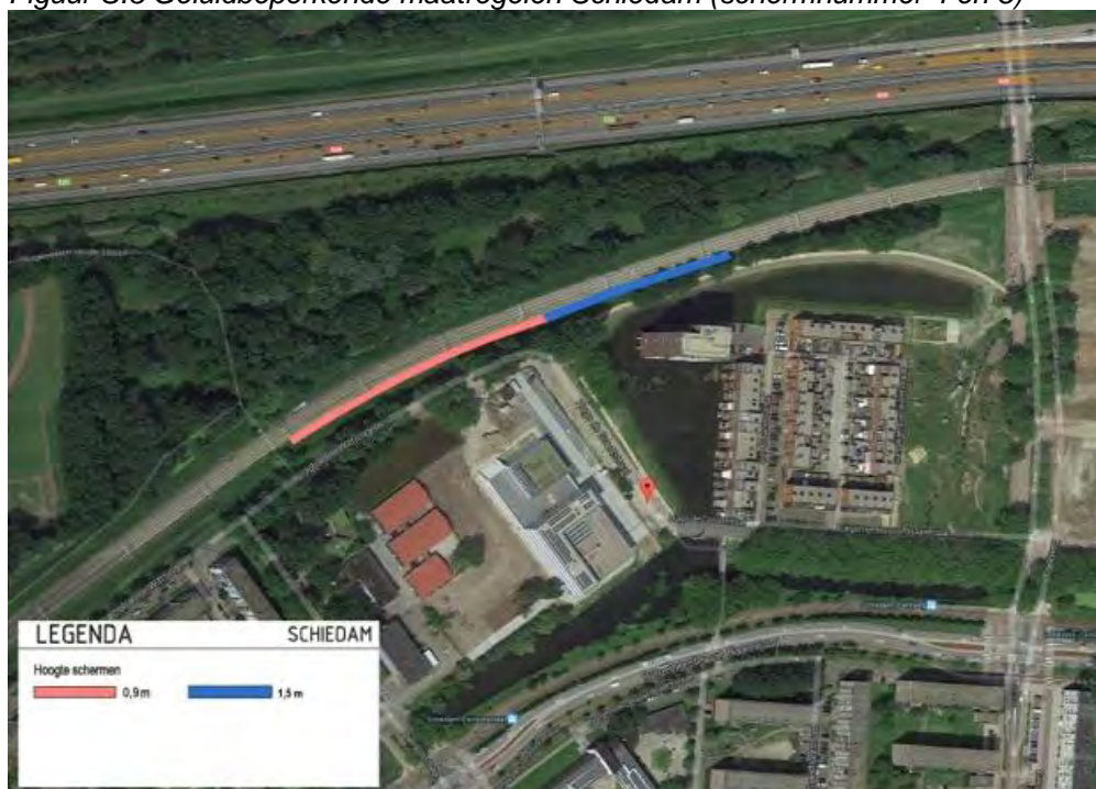
Figuur S.3 Geluidbeperkende maatregelen Schiedam (schermnummer 4 en 5)
