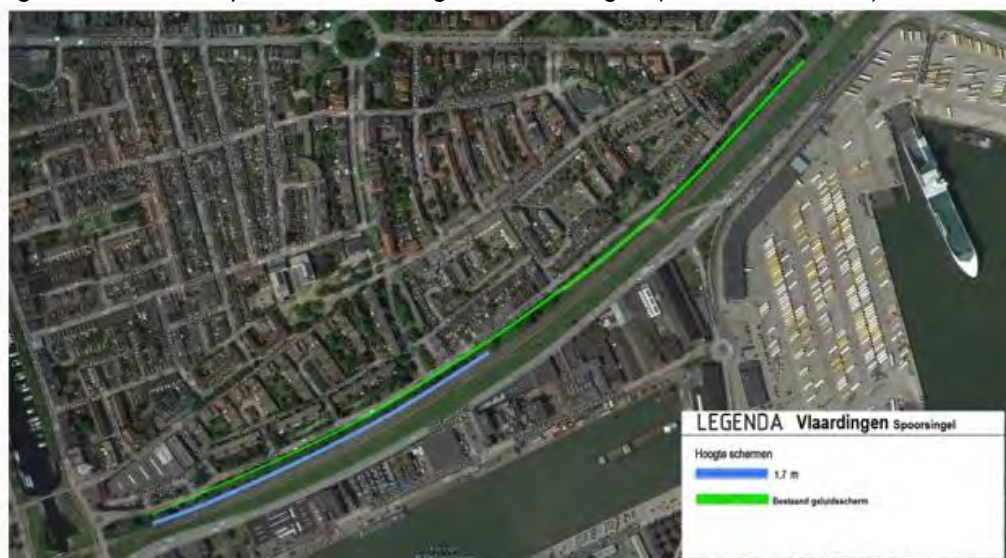
Figuur S.5 Geluidbeperkende maatregelen Vlaardingen (schermnummer 1)
