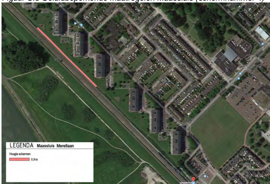
Figuur S.8 Geluidbeperkende maatregelen Maassluis (schermsnummer 4)
