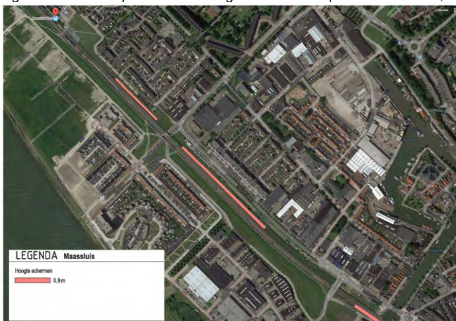
Figuur S.7 Geluidbeperkende maatregelen Maassluis (schermsnummer 1, 2 en 3)
