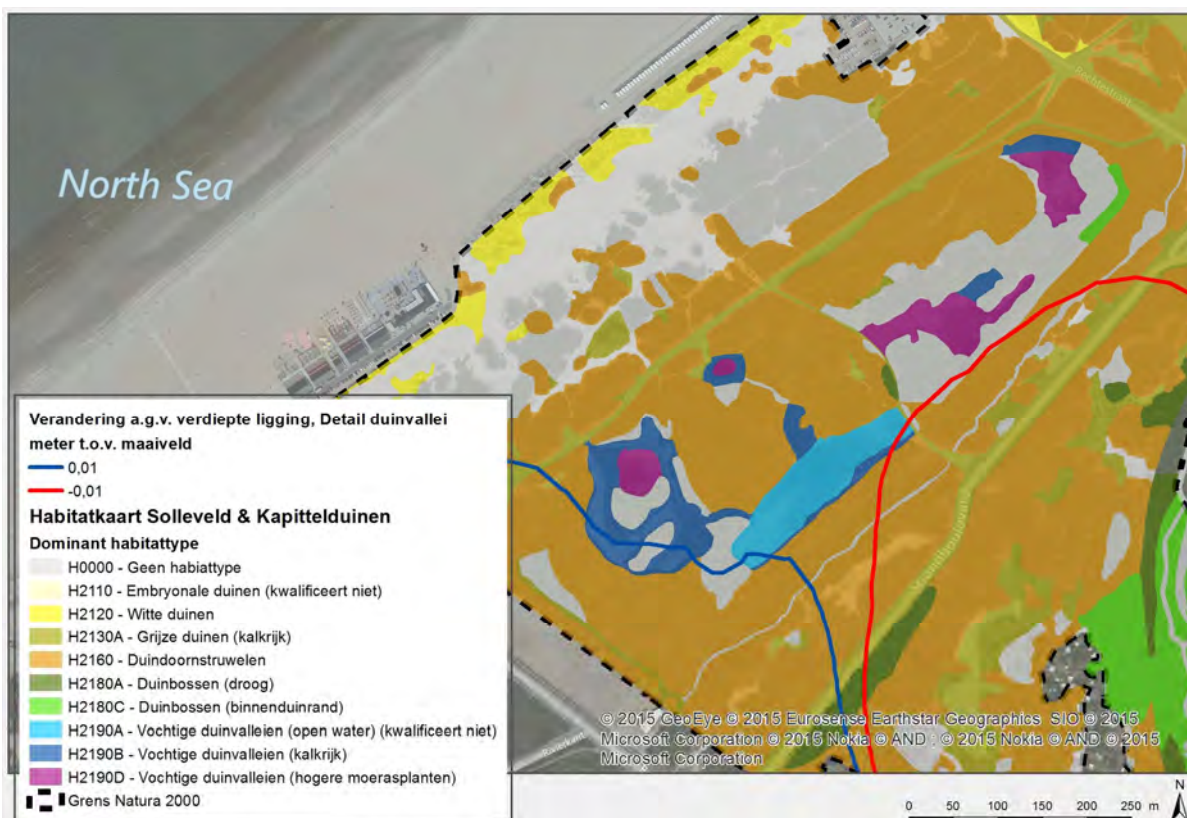
Figuur 6.11 Verandering grondwaterstanden in de variant Verdiepte kruising Strandweg, detail duinvallei
