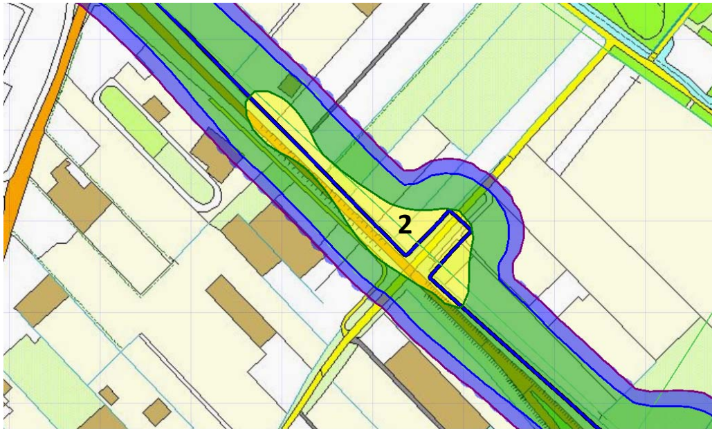
Figuur 2: Ligging PR=10 -6 -contour buisleiding W-535 over volkstuienencomplex
