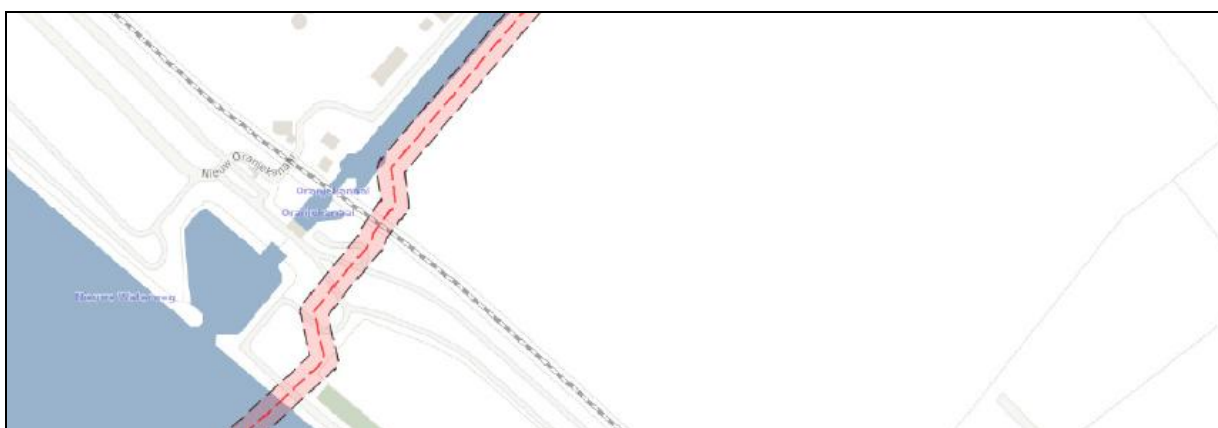
Figuur 4.4 buisleidingen met gevaarlijke stoffen in Hoek van Holland (oostzijde)
