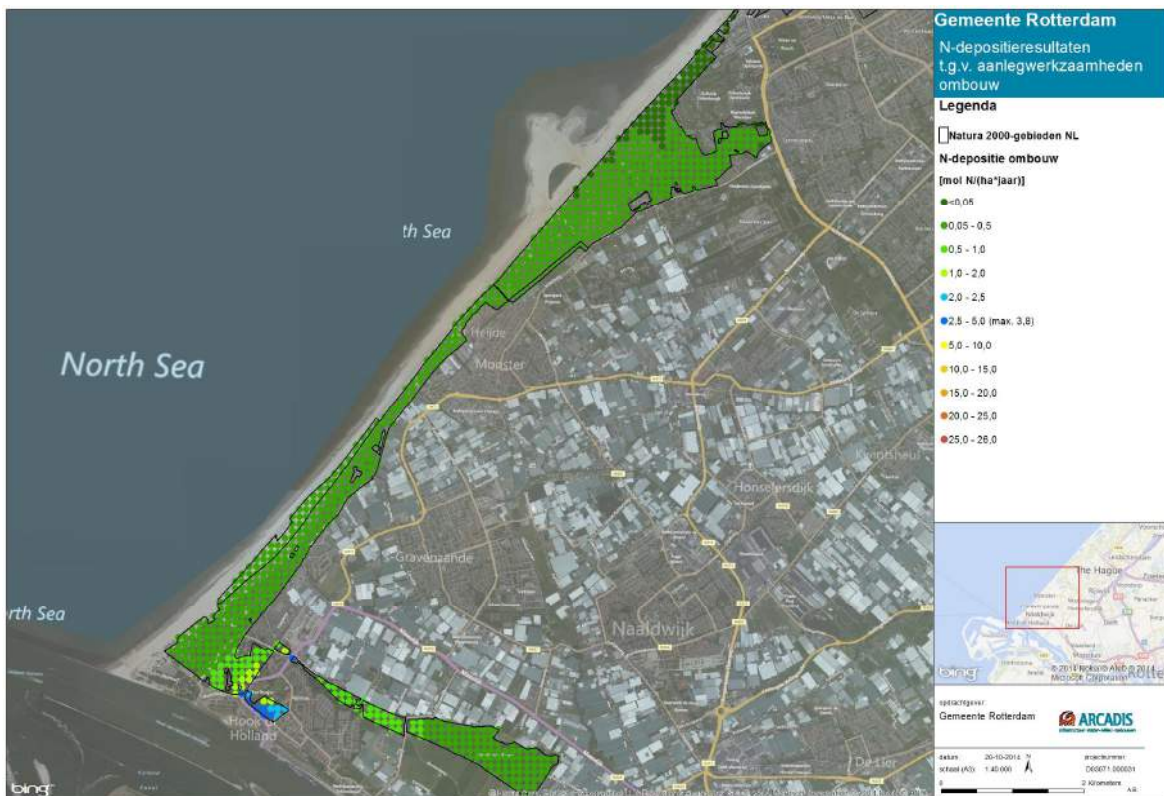
Figuur 5.2 Stikstofdepositie in 2017 door bouwwerkzaamheden van het alternatief Ombouw inclusief transport en tijdelijke bussen
