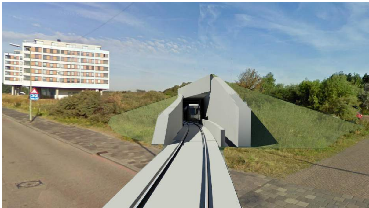
Figuur 6.1 Impressie van de ingang van de gesloten bak onder het Vinetaduin, gezien vanaf de Strandweg.
