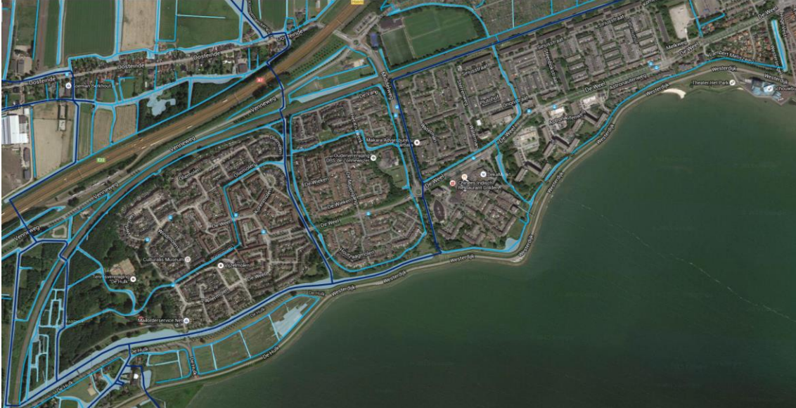
Afbeelding 4.4: primaire, secundaire en tertiaire watergangen zoals opgenomen in de Legger Wateren Hoogheemraadschap Hollands Noorderkwartier.
