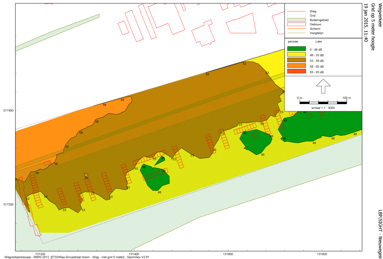
Figuur 3: verloop geluidbelasting als gevolg van Rijksweg A7 waarnaemhoogte 5m+ (geen aftrek artikel 110g).
