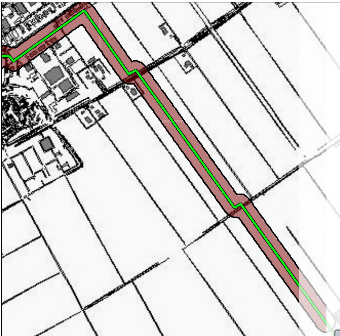
Figuur 4.11a Invloedsgebied gasbuisleiding A-570-012 westelijk deel
