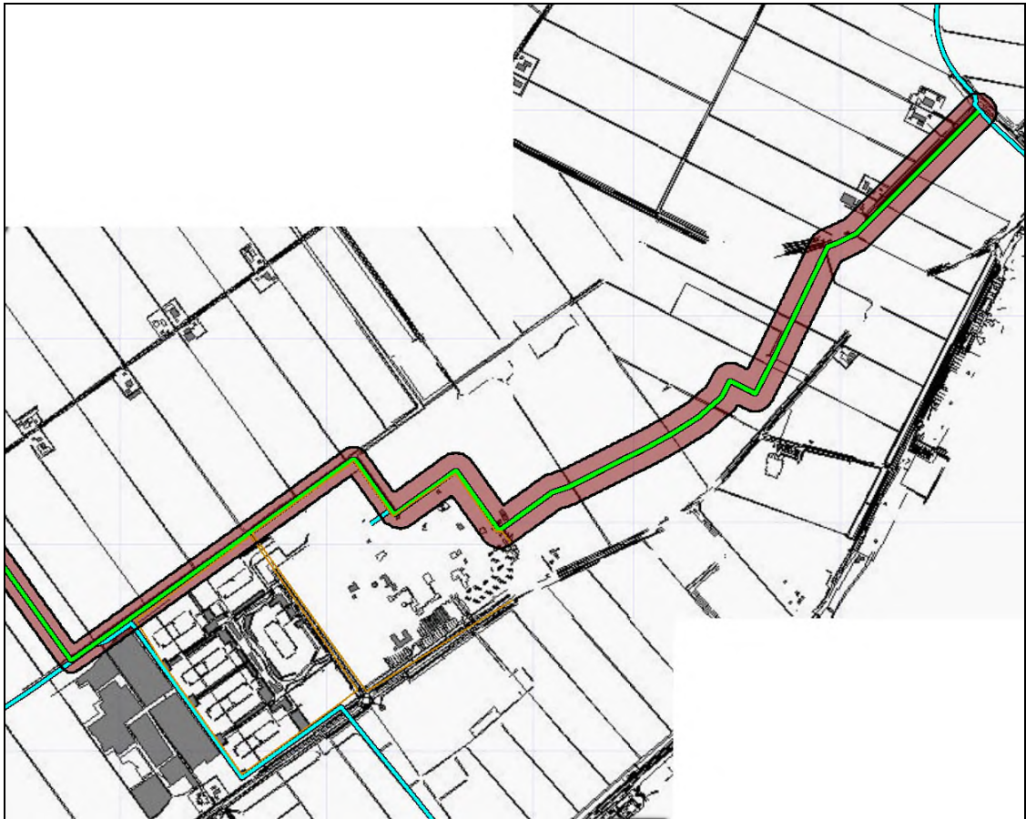
Figuur 4.11b Invloedsgebied gasbuisleiding A-570-12 zuidoostelijk deel
