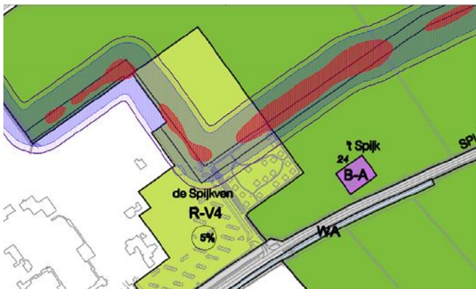
Figuur 15. De 10 -6 -risicocontour ter plaatse van het bungalow- en kampeerterrein 't Spijkven
