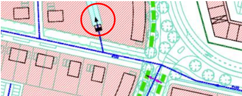
Afbeelding 12 Uitstroomriool door particulier terrein niet toegestaan
