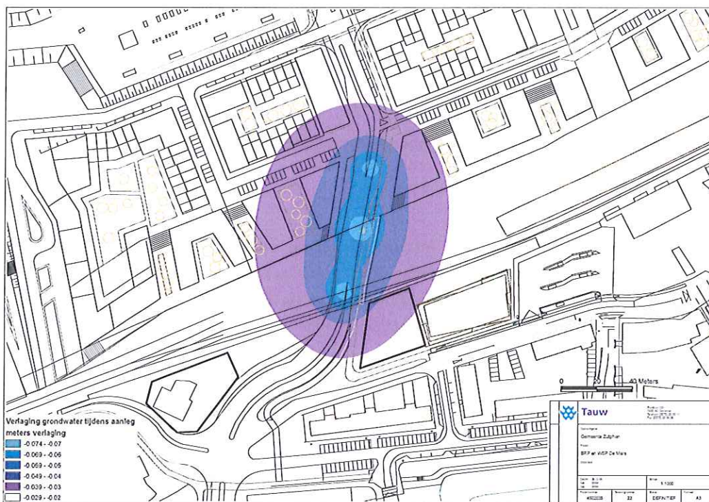
Figuur 4.4 Verlaging grondwaterstand tijdens aanleg, ontgravingsfase
